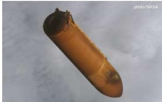
外部燃料タンク(External Tank: ET)の主な機能は、オービターのメインエンジンに燃料の液体水素と酸化剤の液体酸素を供給することである。また、2本のSRBとオービターを接続し、全体を支える骨組みにもなっている。ETはシャトルの中では唯一再使用されない部分である。
