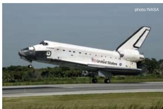
オービター(Orbiter)とは、スペースシャトルを構成しているモジュールの中で、地上と宇宙を往復するように設計された、再利用可能な宇宙船本体部分である。再使用可能な液体ロケットエンジンSSMEを胴体後部に3機搭載しており、オービター外観に取りつけられる固体補助ロケットの推力を合わせて、ロケットのように打ち上げられる。宇宙空間での作業を行った後、大気圏に再突入し、グライダーのように滑空して地上の滑走路に着陸する。帰還時の滑空には翼による揚力を利用しているため、飛行機に近い形状をしており、垂直尾翼も配置されている。本体前部にキャビンがあり、本体中央部は貨物室となっている。機体表面には大気圏突入時の摩擦熱に耐えるために耐熱タイルや強化カーボンなどが張り巡らされている。オービターはエンタープライズ、コロンビア、チャレンジャー、ディスカバリー、アトランティス、エンデバーの6機が製造された。エンデバーは6機のオービターの中でも最も新しい機体である。
