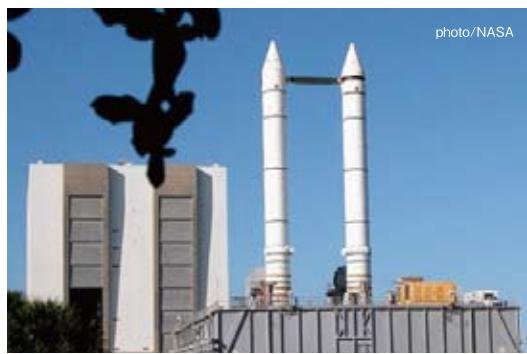
固体燃料補助ロケット(Solid Rocket Booster: SRB)は2機合計で発射時に必要な推力の83%、約1,250万ニュートン(1,276.8トン)を発揮し、発射から2分後、高度約15万フィート(46km)に達したところで切り離され、パラシュートで海に着水して回収される。SRBは何度も再使用される。
